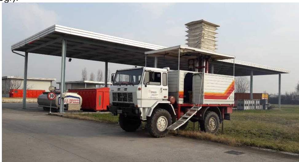
Fig.10. Prove eseguite in sito con penetrometro statico da 300 KN, montato su camion IVECO
